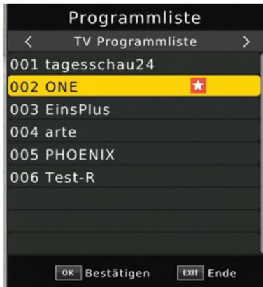
> Sie können nun mit Hilfe der **Pfeiltasten auf/ab** in 1er Schritten und der **Pfeiltasten rechts/links** in 8er Schritten das gewünschte Programm auswählen und mit **OK** bestätigen. Die Programmliste verschwindet wieder durch erneutes Drücken der **OK Taste** oder der **EXIT Taste**.
