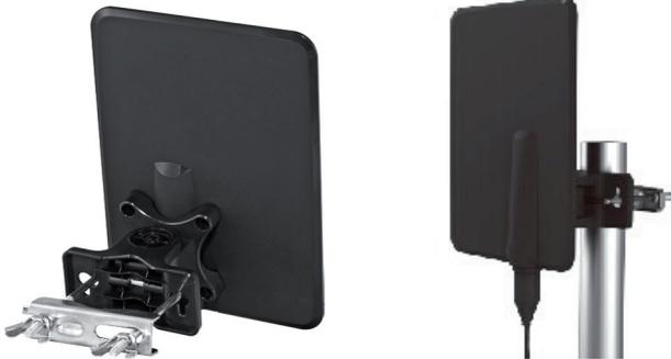
Sie können die Antenne vertikal oder horizontal ausrichten. Wenn die Antenne horizontal ausgerichtet werden soll, lösen Sie die Kreuzschlitzschrauben, lösen Sie den Halter und drehen Sie diesen um 90°.
