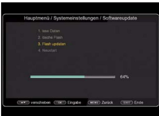
Das Update wird automatisch gestartet. Nach Abschluss des Update-Vorgangs wird der Receiver automatisch neu gestartet. Um das Update zu aktivieren, rufen Sie nach der Softwareaktualisierung die Werkseinstellungen auf. Lesen Sie dazu auch Kapitel 11.4.
