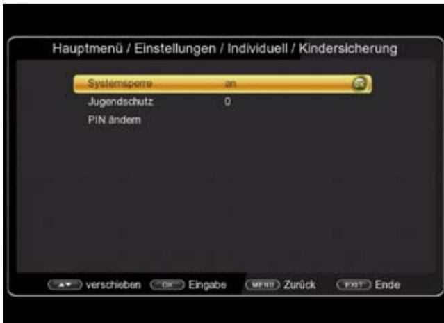
Unter Systemsperr können Sie den Zugang zum Menüpunkt Programm Bearbeitung sperren. So kann z.B. das Löschen von Programmen oder eine Sortierung einzelner Programme gesperrt werden.
