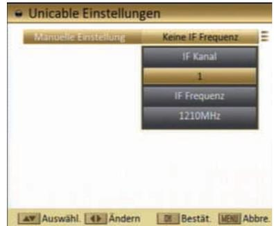
Haben Sie einen zweiten Receiver angeschlossen, wählen Sie in diesem Receiver eine weitere Kanalnummer und Zwischenfrequenz an.
