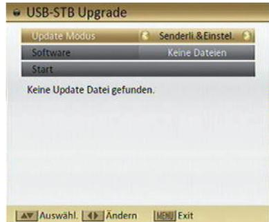
Auf dem Feld "Software" wird die auf dem USB-Stick vorhandene Software angezeigt. Gegebenfalls müssen Sie mit "OK" bestätigen und dann den Pfad für die Update-Datei auswählen, falls der Receiver die Datei nicht automatisch findet.
