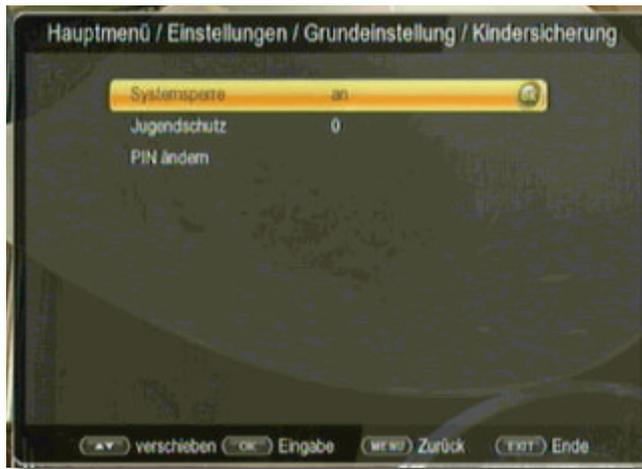
Unter Systemsperrt können Sie den Zugang zum Menüpunkt Programm Bearbeitung sperren. So kann z.B. das Löschen von Programmen oder eine Sortierung einzelner Programme gesperrt werden.
