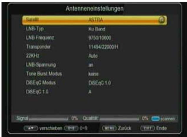
**Hinweis:** Der Receiver ist werkseitig bereits mit den Parametern der gängigsten Satellitenanlagen und Satellitenpositionen voreingestellt. Eine Veränderung der Einstellungen sollte daher nur dann durchgeführt werden, wenn Sie Satellitenpositionen empfangen möchten, die noch nicht im Gerät voreingestellt sind. Bitte befragen Sie dazu auch Ihren Fachhändler oder Installationsbetrieb.
