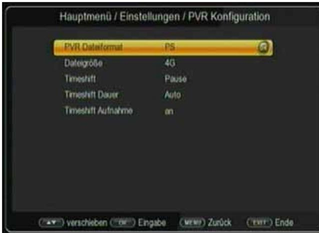
Wählen Sie PS aus, wenn die Datei nach beendeter Aufnahme auf das USB Gerät kopiert werden soll um an einem anderen Gerät angeschaut oder bearbeitet zu werden. Dabei wird die aufgenommene Sendung als MPG File abgespeichert.
