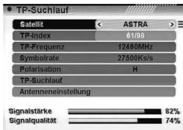
1. Drücken Sie unter dem Menüpunkt „Satellit“ auf **[Vol ◀▶]**, um den Satelliten auszuwählen, für den Sie einen Suchlauf ausführen möchten oder drücken Sie **[OK]**, um die Satellitenliste zu öffnen und wählen Sie den Satelliten direkt mit **[CH ▲ ▼]** aus; drücken Sie zur Bestätigung auf **[OK]**.
