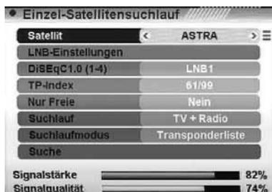
2. **LNB-Konfiguration:** Drücken Sie **[OK]**, um die LNB-Konfiguration einzugeben; das nebenstehend abgebildete Fenster wird angezeigt.
