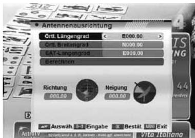
1. Verwenden Sie die Zifferntasten, um die Werte für „Örtlichen Längengrad“, „Örtlichen Breitengrad“ und „SAT-Längengrad“ einzugeben.
