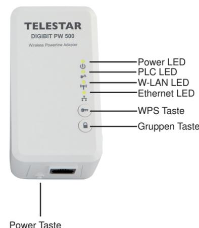
**Eine gesicherte Verbindung über PLC herstellen**
