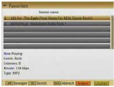
In der Favoritenliste können Sie Namen der Sender ändern. Hierzu drücken Sie die rote Taste. Ändern Sie jetzt mit Hilfe der Fernbedienungstasten den Namen. Bestätigen Sie die Eingabe mit dem gelben Menüpunkt "OK". Mit der gelben Taste können Sie Programme aus der Liste entfernen. Drücken Sie die gelbe Taste "löschen" und bestätigen Sie jetzt die Abfrage mit "OK" oder "Abbruch".
