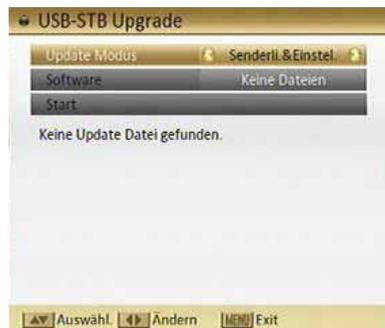
Auf dem Feld "Software" wird die auf dem USB-Stick vorhandene Software angezeigt. Gegebenfalls müssen Sie mit "OK" bestätigen und dann den Pfad für die Update-Datei auswählen, falls der Receiver die Datei nicht automatisch findet.
