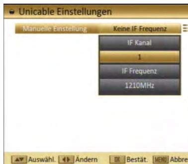
Haben Sie einen zweiten Receiver angeschlossen, wählen Sie in diesem Receiver eine weitere Kanalnummer und Zwischenfrequenz an.
