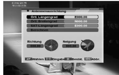
1. Verwenden Sie die Zifferntasten, um die Werte für „Örtlichen Längengrad“, „Örtlichen Breitengrad“ und „SAT-Längengrad“ einzugeben.
