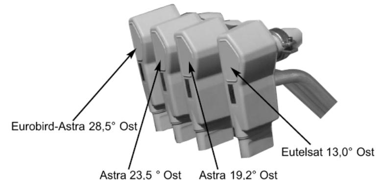
3. Verbinden Sie die Ausgänge der LNBs durch geeignete Koaxialkabel mit den Eingängen eines Multischalters z.B. StarSwitch 17/8. Dabei sind die LNBs den empfangbaren Orbitalpositionen gemäß oben stehender Tabelle zugeordnet.
