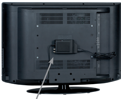
Installationsbeispiel: TELEMINI HD an Geräte-rückseite LCD-Fernseher
