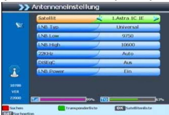
**Hinweis:** Der Receiver ist werkseitig bereits mit den Parametern der gängigsten Satellitenanlagen und Satellitenpositionen voreingestellt. Eine Veränderung der Einstellungen sollte daher nur dann durchgeführt werden, wenn Sie Satellitenpositionen empfangen möchten, die noch nicht im Gerät voreingestellt sind. Bitte befragen Sie dazu auch Ihren Fachhändler oder Installationsbetrieb.
