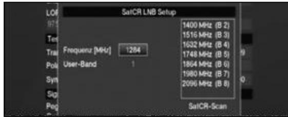
**Beachten Sie**, dass jede Teilnehmerfrequenz des SatCR LNBS nur jeweils **einem** Gerat zugeordnet werden darf, da es sonst zu gegenseitigen Beeinflussungen im Empfang und Umschaltverhalten der Gerate kommt.
