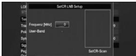
Markieren Sie das Feld **SatCR Scan** und drücken Sie die Taste **OK**, um das SatCR LNB Setup zu starten.
