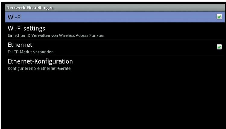
Wenn Sie z.B. das Gerät über ein Netzkabel mit einem Router verbunden haben, so wählen Sie mit Hilfe der **Navigationsstasten** das Feld *Ethernet* an und bestätigen Sie mit **OK**.
