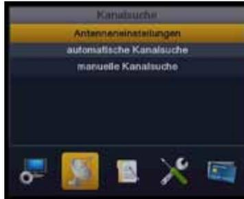
**Antenneneinstellungen:** Konfigurieren Sie Ihren Receiver der Satellitenanlage entsprechend. Eine werksseitige Voreinstellung ist in diesem Receiver schon integriert und muss nur in Einzelfällen geändert werden.
