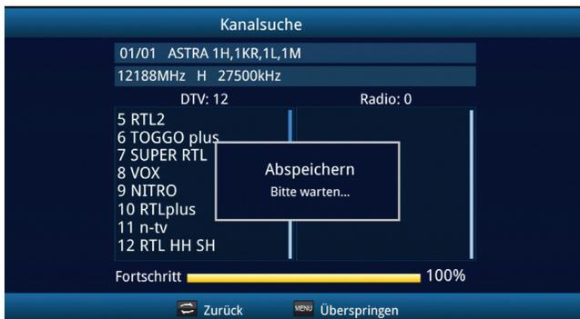
Der Suchlauf kann jederzeit durch Drücken der Taste **EXIT** abgebrochen werden. Wenn Sie die bereits gefundenen Sender speichern möchten, bestätigen Sie nach beendetem Suchlauf oder nach Abbruch über **EXIT** die Abfrage mit *Ja* oder *Nein*. Die gefundenen Programme werden am Ende der Programmliste hinzugefügt.
