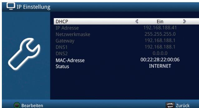
Sollte das Gerät über Netzwerkkabel mit dem Heimnetzwerk verbunden sein, sollte der Konfigurationsmodus auf DHCP stehen. Dies ist die reguläre Einstellung muss in der Regel nicht verändert werden.
